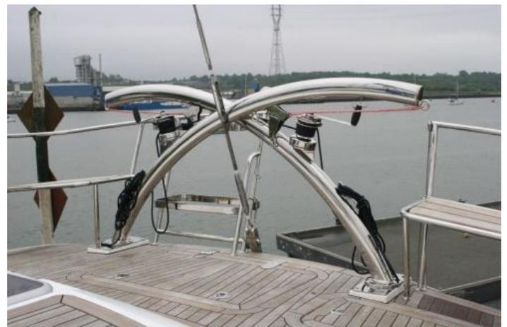
Diese innovativen Davits sind eine formschöne Ergänzung zu den bisherigen Simpson Davit Modellen. Dieses System hebt den Tender mittels einer Talje (manuelle Bedienung über eine horizontal montierte Winsch) in ausreichendem Abstand zur Badeplattform. Sobald der Tender oben ist, wird er eingeklappt und sicher unter den Davits geborgen. Für Deckmontage.
