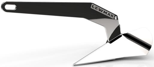
Hergestellt aus Edelstahl AISI 316 / A4. Innerhalb der Spitze des Ankers befindet sich ein verkapselter Bleiballast. Dadurch entsteht der perfekte Schwerpunkt. Dies gibt dem DTX® "Biss" und zuverlässige Haltekraft, die Nutzer des Delta™ Ankers zu schätzen gelernt haben.
