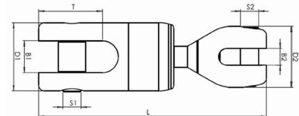
Drehbarer Anker-Ketten-Verbinder aus Edelstahl. Besonders hohe Bruchlast mit Werten über denen der entsprechenden Kette. Aus AISI 316L / A4L Edelstahl.
