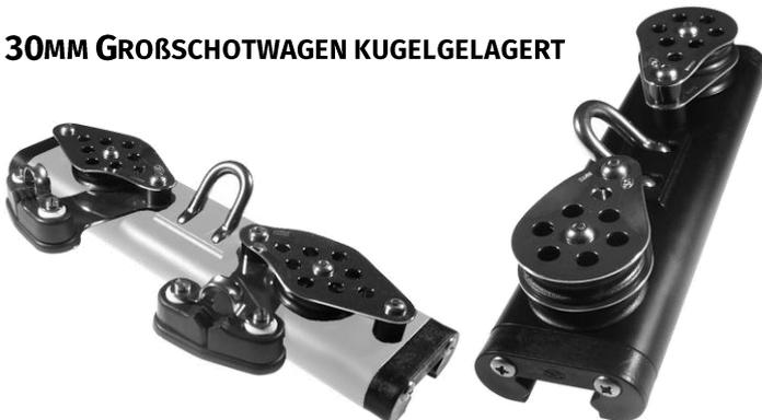
Kugellager Großschotwagen rollen über eine Umlauf Kugellagerung auf der Schiene und haben einen Edelstahl Schäkel zur Aufnahme von Blöcken oder Tauwerk. Die Trimmleinenrollen sind 45x12mm groß (nur OH03050 hat einen Bügel und kleine Rollen!), SWL 300kg je Scheibe, Travellerleine max. 10mm.
