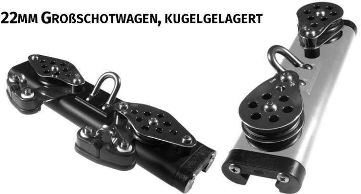
Kugellager Grobschotwagen (SWL 1000kg) rollen über eine Umlauf Kugellagerung auf der Schiene und haben einen Edelstahl Schäkel zur Aufnahme von Blöcken oder Tauwerk. Die Trimmleinenrollen sind 35x10mm groß (nur OH2250 hat einen Bügel und kleine Rollen!), SWL 300kg je Scheibe, Travellerleine max. 8mm.
