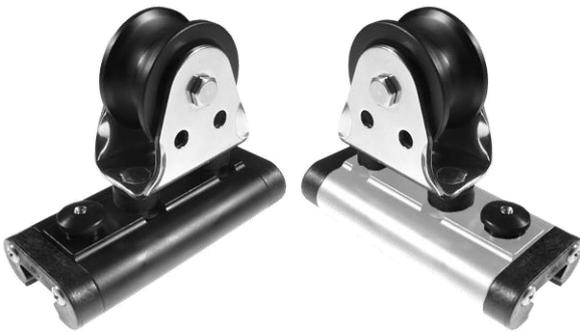
Kugellager Genuawagen rollen über eine Umlauf Kugellagerung auf der Schiene und haben ein Edelstahl Schotrollengehäuse, in dem 60 x 33mm große Schotrollen laufen. Die Trimmleinenrollen sind 45x12mm groß, SWL 500kg je Scheibe, Travellerleine max. 10mm.
